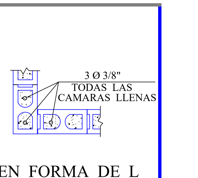
D5 DETALLES JUNTAS MUROS DE BLOCKS ESCALA 1:20
